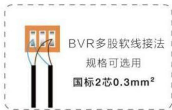
接线方式：设备进设备出，线管内不破/断线
